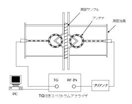
図3KEC法の測定原理図(磁界シールド)
