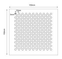
図2 孔の開いた銅箔プリント基板
