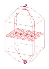
図4 シミュレーションモデル (電界用)
