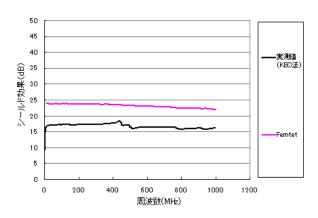
図9 孔の空いた基板のシールド効果(磁界)
