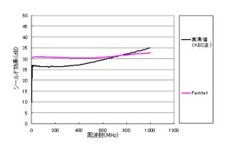
図8 孔の空いた基板のシールド効果(電界)
