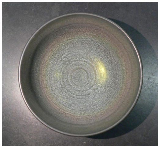
図6. 同心円状の虹色をデザインした陶器試作品の外観写真 内側のカーブによって光の角度が異なり緑～赤が見える
