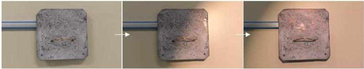
図4 制作した陶器（エアプランツホルダー）を壁に立て掛けて正面からペンライトで照らした様子；赤色の構造色が見える。
