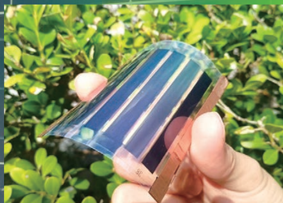
図1：フィルム型のペロブスカイト太陽電池モジュール
