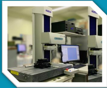
接触式表面形状測定機の実習
