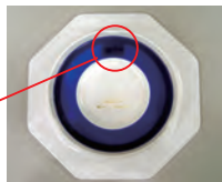
ICタグが埋め込まれている回転寿司のお皿の裏面
