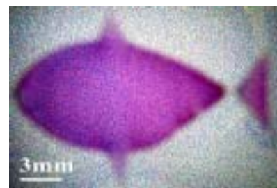
図 5：ガラス基板上でのコロイド結晶膜のパターンの作製。(a)作製方法、(b)コロイド結晶膜の写真。
