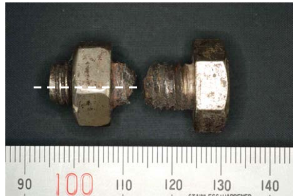
図1 破断したボルトの外観写真
