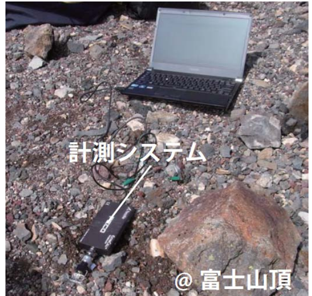
富士山頂での膜タンパク計測システムの写真。 世界で最も高い場所での膜タンパク質チャンネル電流計速に成功しました。
