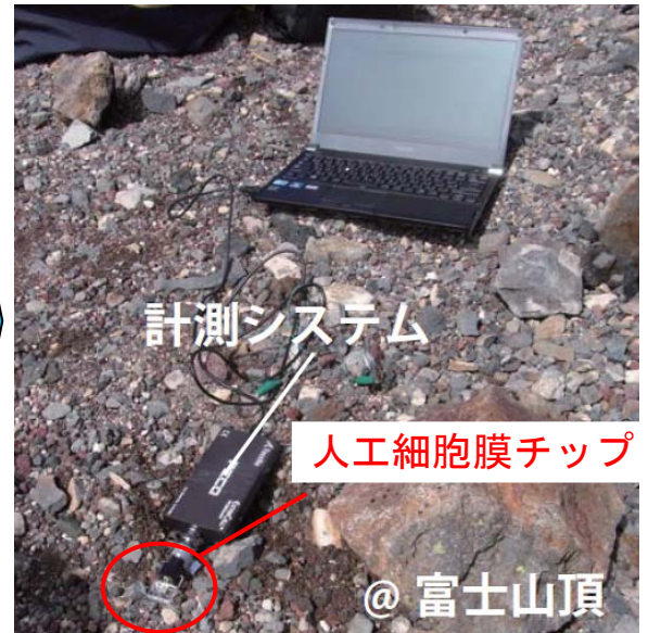
図 2 開発した膜タンパク質のイオン電流計測システム
