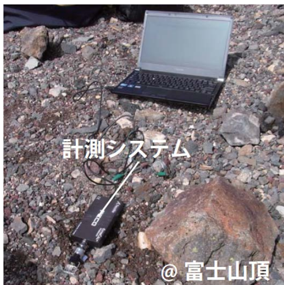
図 1 開発した膜タンパク質のイオン電流計測システム
