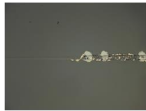
膜損傷検出 スクラッチ試験によるはく離痕
